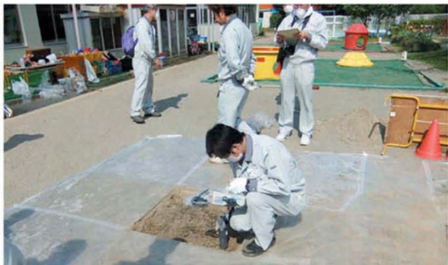
●小学校の線量調査・除染 福島県に協力して、福島市内の小中学校3校の校舎や通学路の線量調査と除染を実施しました。
